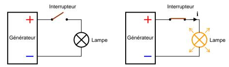
Un courant électrique ne peut s'établir que dans un circuit électrique fermé. Celui-ci doit contenir au moins un générateur électrique et un récepteur. Des conducteurs (fils) relient les différents éléments du circuit. L'interrupteur permet d'autoriser ou non le passage du courant électrique.
